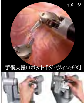
医師が機器を操作(下)することでロボットアームの先端が動く(上)
